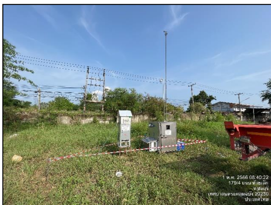
รูปที่ 3.5 การเก็บตัวอย่างคุณภาพอากาศในบรรยากาศ บริเวณบ้านห้วยเล็ก
