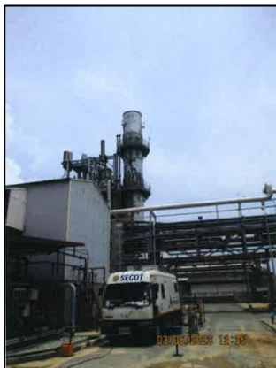
รูปที่ 3.1 การเก็บตัวอย่างคุณภาพอากาศจากแหล่งกำเนิด บริเวณปล่อง HRSG#1
