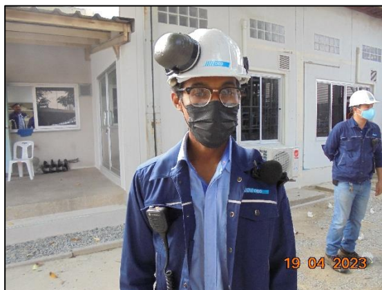
รูปที่ 3.12 การตรวจวัดระดับเสียงสะสมแบบติดที่ตัวบุคคล (Noise Dose)
